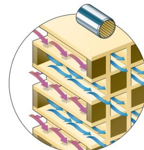
Il rivestimento catalitico velocizza qui la conversione del NO contenuto nel gas di scarico in „comburente“ NO<sub>2</sub>, che ossida la fuliggine (composta da carbonio) accumulata nel filtro e a questo punto avviene la combustione delle particelle.
